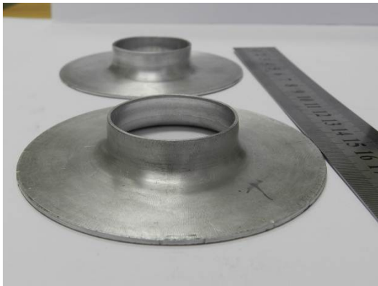
Рис. 3. Традиційна та зпрофільовані заготовки після відбортуння
