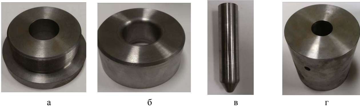
Рис. 2. Штамп для відбортування: а – нижня плита; б – матриця; в – пуансон; г – контейнер
