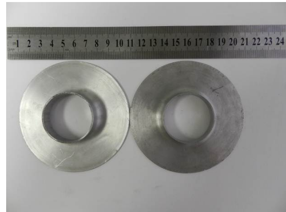
Рис. 3. Традиційна та зпрофільовані заготовки після відбортуння
